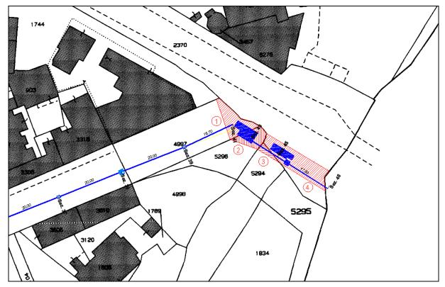
Le acque di prima pioggia (sottoposte a grigliatura e dissabbiatura) e le acque di dilavamento (sottoposte alla sola grigliatura) rivenienti dalla rete di fognatura pluviale, verranno sversate nel canale tombato "Lama Belvedere".
