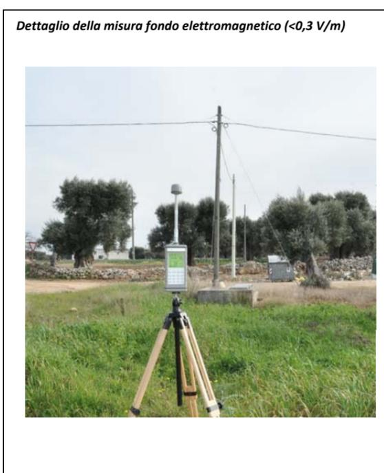
Dettaglio della misura fondo elettromagnetico (<0,3 V/m)
