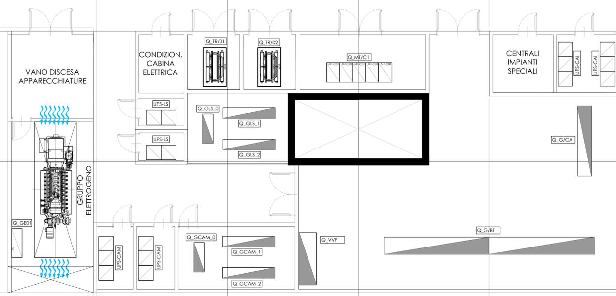
TIPOLOGICO SULLA DISPOSIZIONE DELLE APPARECCHIATURE ELETTRICHE DI CABINA - CABINA C1 E CABINA C2 -
